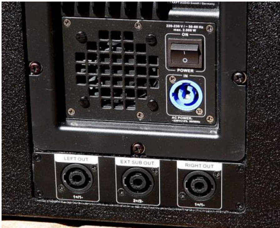
Aktiver Lüfter und drei Anschlüsse für Passivboxen
